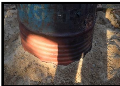
(d) Sealing the bottom air vents
