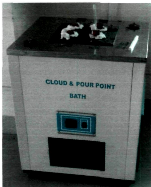
Fig.3.6. Cloud point & pour point bath
